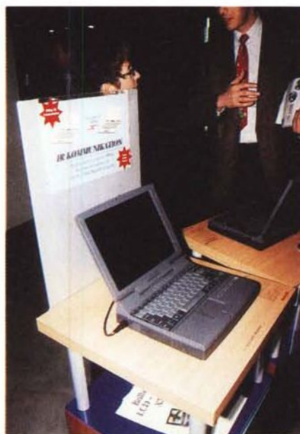
Questi due computer portatili stavano colloquiando tramite la porta IrDa ad una velocità fantasmagorica... 4 Mbit/s
